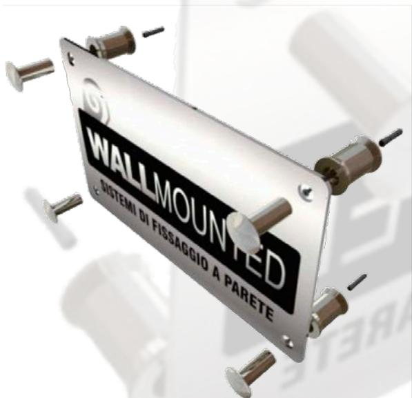
Kit composto da 4 distanziali con finitura cromata, sistema di chiusura laterale con grano di fissaggio e brugola.
